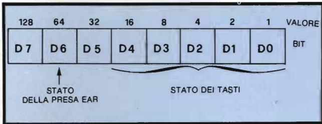
Figura 2. Struttura del byte dati, letto da ciascun port di tastiera.
